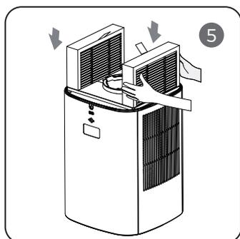
Installez les nouveaux filtres dans le le purificateur d'air. Les tirettes doit faire face vers l'intérieur.
