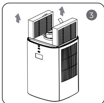
Tirez sur les languettes pour retirer l'ancien filtre du purificateur d'air.
