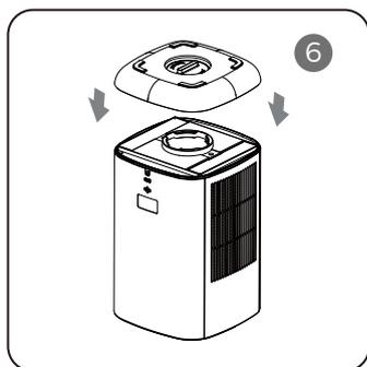
Bringen Sie den Sockel am Produkt an und ziehen Sie den Drehknopf entsprechend der Richtungsmarkierung fest.
