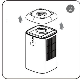
Den Boden entfernen und beiseite stellen.
