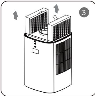
Nehmen Sie die neuen Filter (in Plastikfolie eingewickelt) aus dem Produkt.
